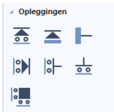
Figuur 4.1 Opleggingen . Overgenomen uit 'Technosoft Raamwerken'
