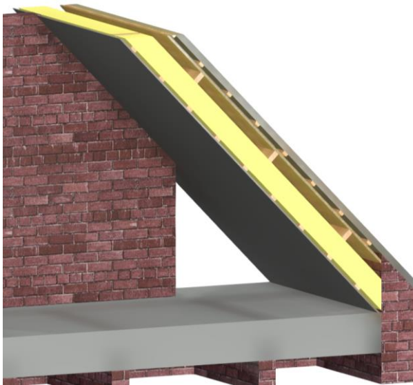
Figuur 40. Dakdetail isolatie tegen gording
